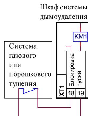
На рис. слева показан пример схемы блокировки шкафа управления вентилятором общеобменной вентиляции при включении вентилятора противодымной вентиляции.
