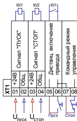
При использовании шкафа в системах противопожарной защиты, команду на пуск привода следует подавать управляющим напряжением.
