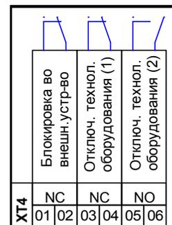
На схеме показано состояние контактов формирования извещений при отключенном приводе.
